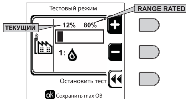
рис. 79- Режим TEST (например, мощность отопления = 80%)
